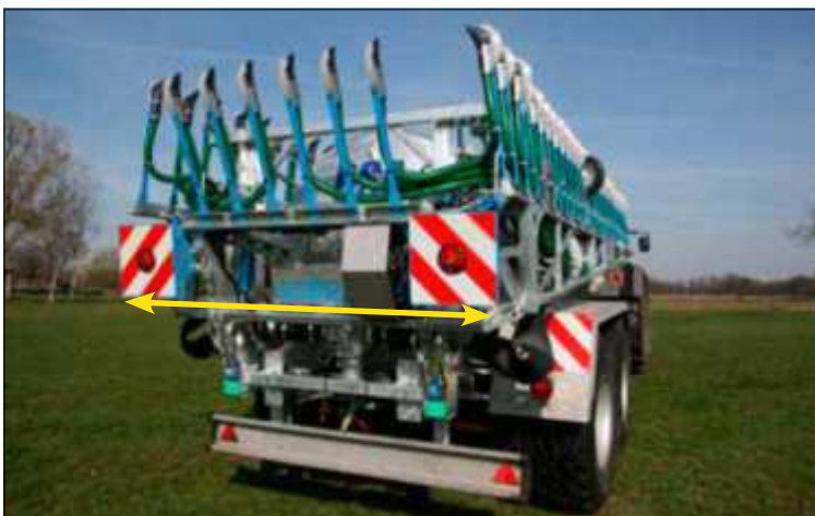
Erittäin kompakti kuljetusasento ( vain 2,55 m)
