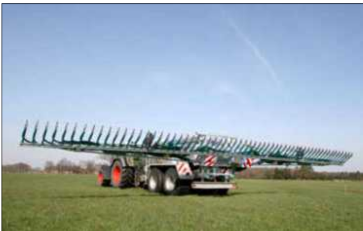
Erittäin kompakti kuljetusasento ( vain 2,55 m)
