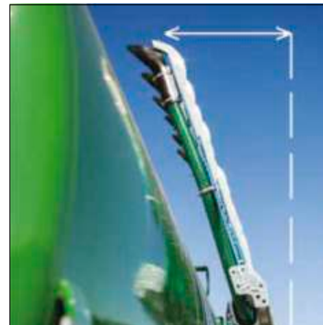
Kuljetusasennossa jouset ovat kallistettuna sisäänpäin
