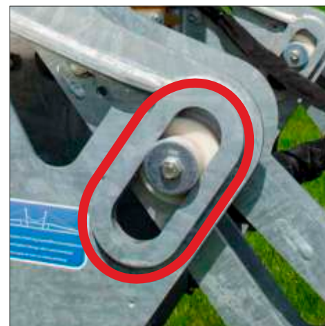
Kuljetusasennossa jouset ovat kallistettuna sisäänpäin
