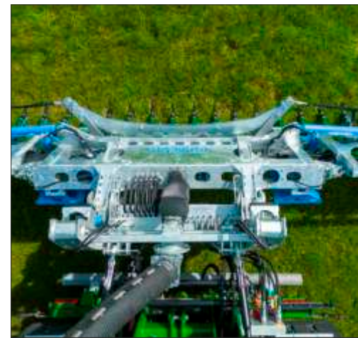
Vahvistettu päärunko + teräsvaijerijärjestelmä
